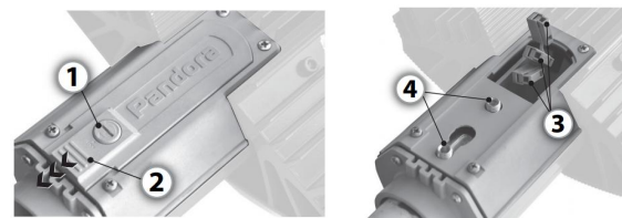
Рисунок 2. Схема установки светильника на кронштейн.
